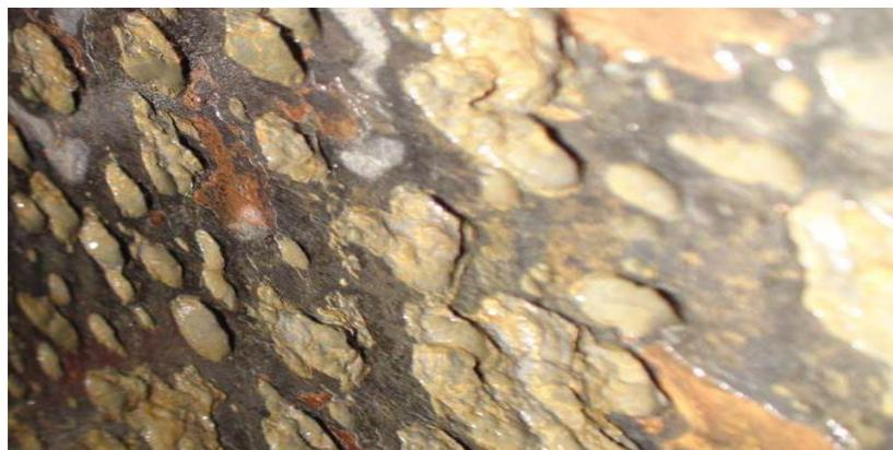
*Язвенная коррозия внутренней поверхности*
